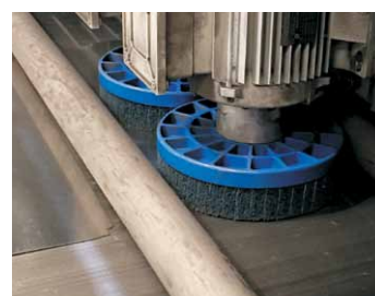
Entgratschleifteller FAPI-250 im Einsatz auf einem Loewer DiscMaster 4TD
