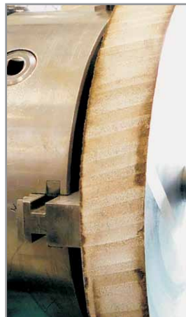
Kontaktscheiben-Kern nach dem ersten Abdreh-Vorgang.
