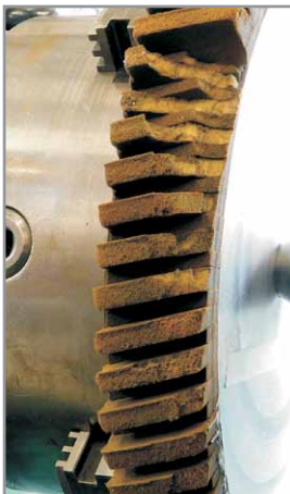
Kontaktscheibe mit einem Altbelag aus Lamellen aus aufgeschäumtem Vulkollan®
