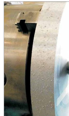
Kontaktscheiben-Kern nach dem finalen Abdrehen - bereit für einen Neubezug.
