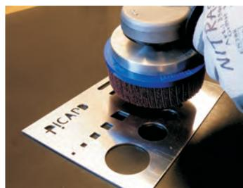
Entgrat Schleifteller FAPI-M14 im Einsatz auf einem Winkelschleifer
