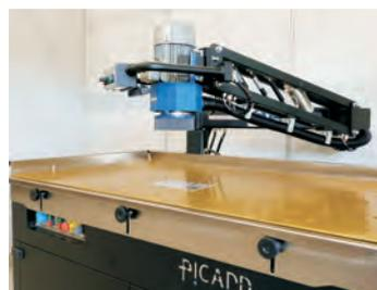
Entgrat Schleifteller FAPI-FIT auf der Entgratmaschine STARGRINDER
