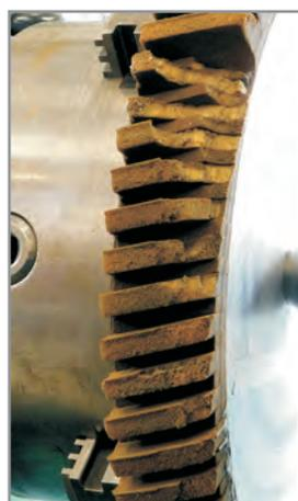
Kontaktscheibe mit einem Altbelag aus Lamellen aus aufgeschäumtem Vulkollan®
